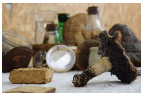
Des champignons pour stopper la pollution plastique. La culture de mycélium mélangée à des déchets agricoles permet de créer un matériau d'emballage solide et entièrement biodégradable. © Fungus Sapiens.
